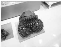
図2: 掘削に使用されたビット
