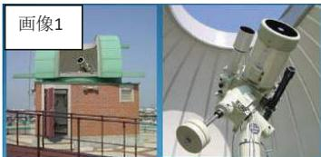
宮城県大崎市にある大崎生涯学習センターの屋上天文台に設置している、30cmカセグレン式望遠鏡と冷却CCDカメラ SBIG社製※画像1をお借りして、画像を撮影し、光度・位置測定ソフト「Atstometrica」で光度を測定する。2013年8月3日の午後9時から撮影を行った。
